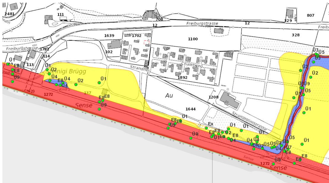
Abbildung 1: Aktuelle Gefahrenkarte Hochwasser der Gemeinde Neuenegg [1]. Der Index Ü steht für den Prozess Überflutung, der Index E markiert Bereiche, die von Seitenerosion betroffen sind. Die Zahlen hinter dem Index beziehen sich auf das Gefahrenstufen-diagramm (siehe [2]).
